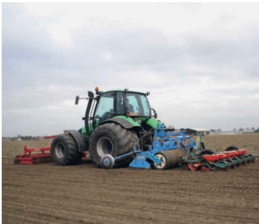
Minimaal berijden van het land in het voorjaar, zaaibedbereiding en zaaien in één werkgang. Foto genomen bij een SUSY-topteler.
