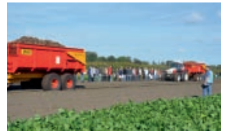
Foto 6. Richard Korver (DLV Plant) meldde het resultaat van de bandendemo. Op de juiste lage bandspanning is de capaciteit op deze losse grond ongeveer 20% hoger.
